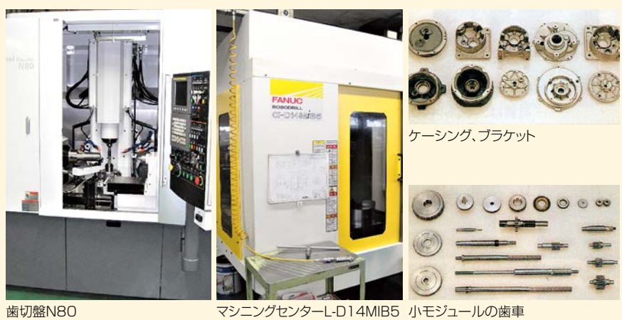
歯切盤N80 マシニングセンターL-D14MIB5 小モジュールの歯車
