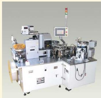
ADMAC-E Vチップ型アルミ電解コンデンサ製造設備
