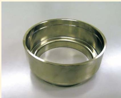
①プレス加工+NC旋盤加工サンプル
