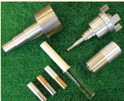
内径圧接を含む異材質圧接品
