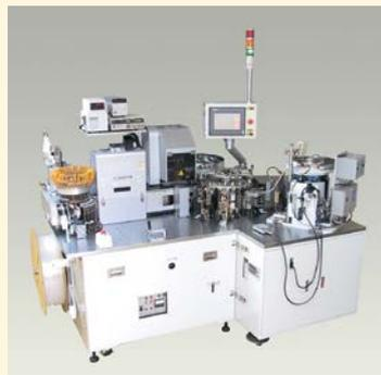
ADMAC-E Vチップ型アルミ電解コンデンサ製造設備
