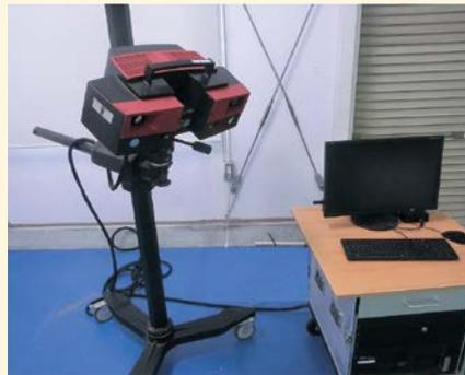
非接触三次元測定機 (ATOS II Triple Scan)
