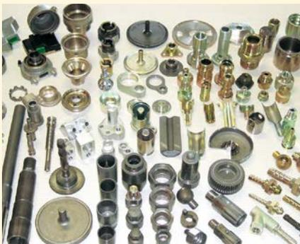
冷間鍛造、切削加工製品群
