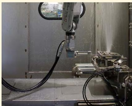
6軸制御多関節ロボットにより複雑な形状のワークも自在に洗浄が可能です。
