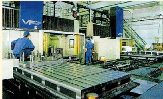
設備:大型MC五面加工機
