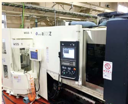
最新鋭、5軸制御横型マシニングセンター
