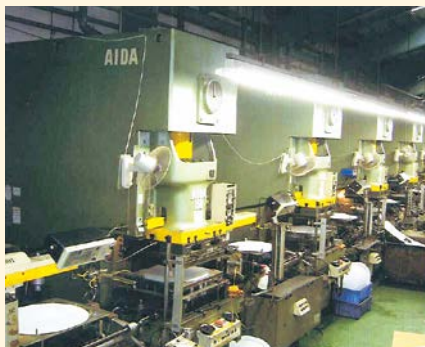
RYロボット150tx7台編成
