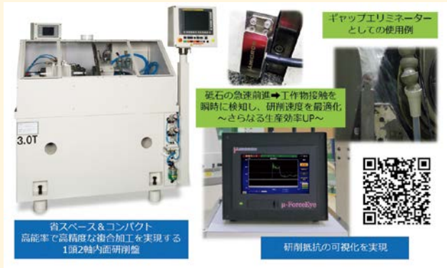
内面研削盤MIG-101i-AO型機と動力計μ-ForceEye
