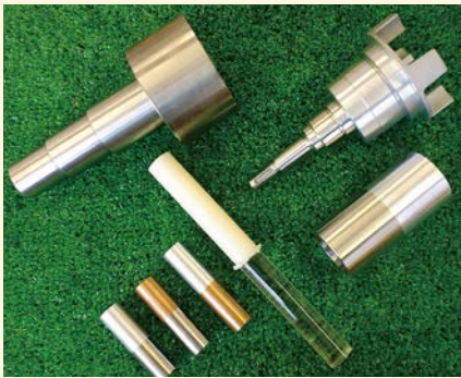
内径圧接を含む異材質圧接品
