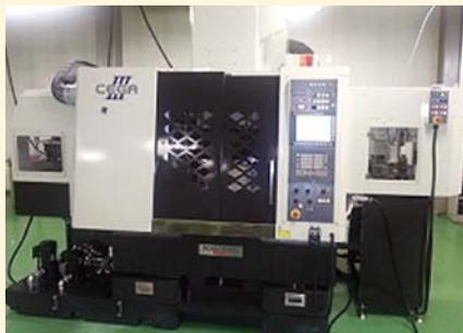
5軸マシニングセンタによる工程集約、連続無人運転 精密金型部品の一例
